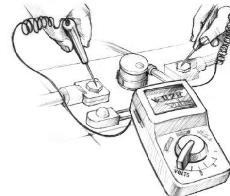
4. Spannung der Zellen messen (nach Ladung)
