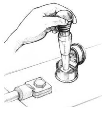
2. Elektrolytdichte messen (nach Ladung)
