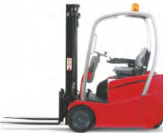
Elektro-3-Radstapler 0,8 - 1,5 to 24 Volt
