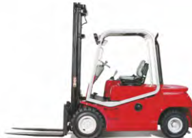
Treibgas-/Dieselstapler 1,5 - 3,5 to hydrostatischer Fahrtrieb
